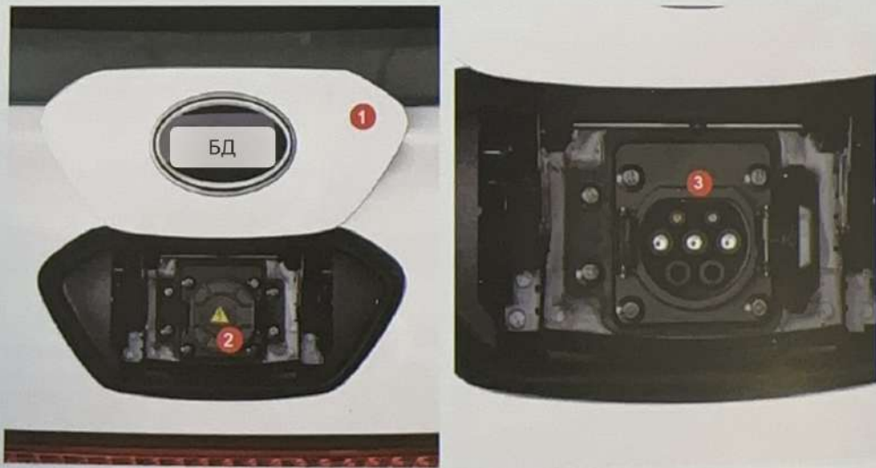
Рисунок 3.1 Расположение порта зарядки корпуса
